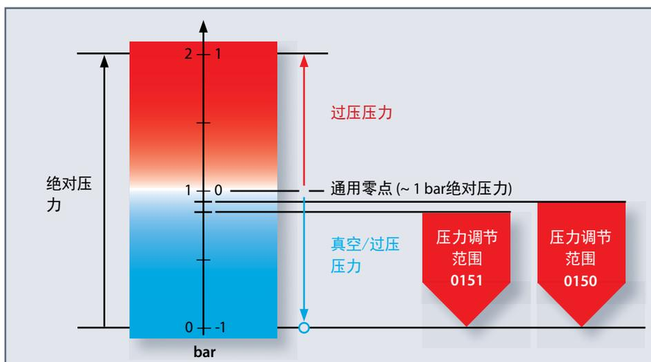
备注：真空开关中设定的压力必须与环境压力（一般压力）相关。
